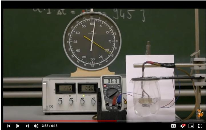
Was ist eigentlich... Innere Energie? (Ermittlung der Kalorimeterkonstante aus el. Heizexperiment)
