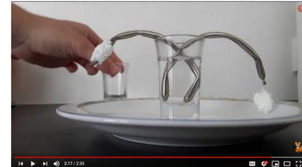
Was ist eigentlich... eine Heatpipe? (Vergleich der Wärmeleitfähigkeit intakte/defekte Heatpipe)
