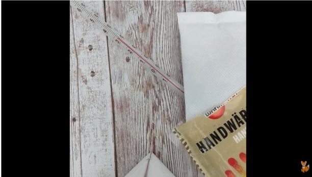
Was ist eigentlich...eine exotherme Reaktion? (Handwärmer: Eisen oxidiert unter Wärmeabgabe zu Rost)
