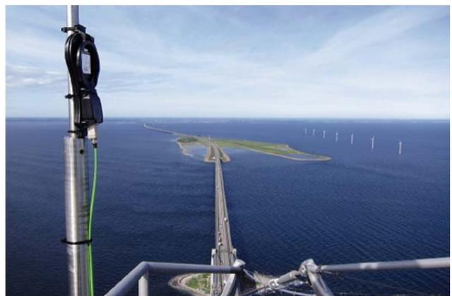
**Bild 4b** LM-S Blitzstromsensor auf der Großer Belt Brücke in Seeland, Dänemark
