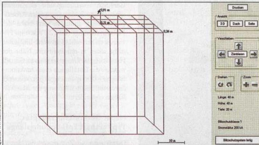
**Bild 3:** Berechnung des Trennungsabstandes für ein Blitzschutzsystem auf einem Flachdach mit zusätzlicher Fangstange. Die Fangmaschen sind an einigen Stellen unterbrochen, z. B. wegen Gebäudeaufbauten. Der Trennungsabstand ist hier angegeben für Spitze und Fuß der Fangstange und für eine Dachecke; der Blitzeinschlag erfolgte hier in die Spitze der Fangstange
