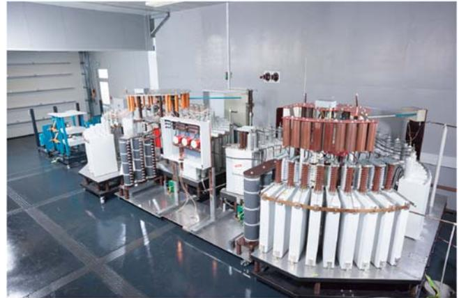
**Bild 9** Tandem-Stoßstromgenerator für einen Blitzstrom bis 400 kA, 10/350 µs.
